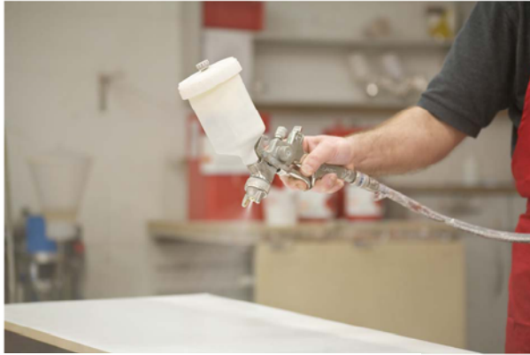
Abb.1: Auftrag des Isolierfüllers
