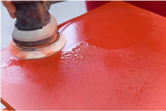
Abb. 5: Nach dem Planschliff (Korn 800-1000) erfolgt der hier abgebildete Nassschliff mit Korn 1200-1500
