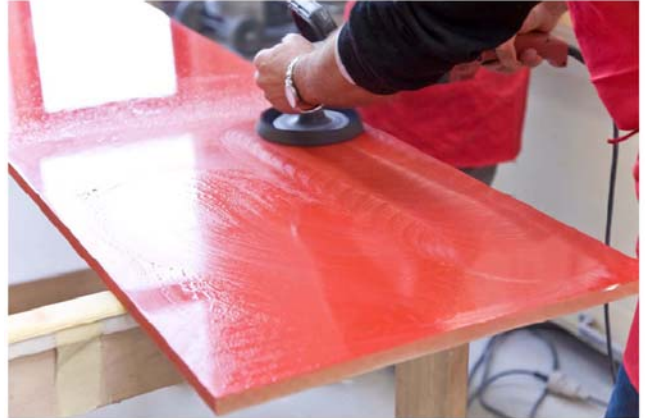
Abb. 6: Hochpolieren mit Hilfe einer Polierpaste
