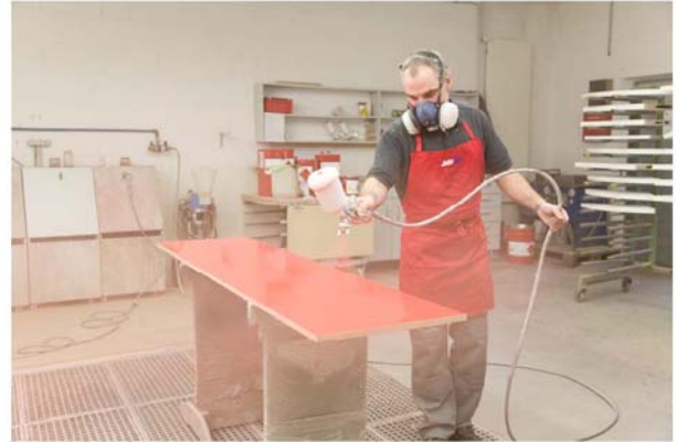
Abb.2: Applizieren der mehrfarbigen Schicht
