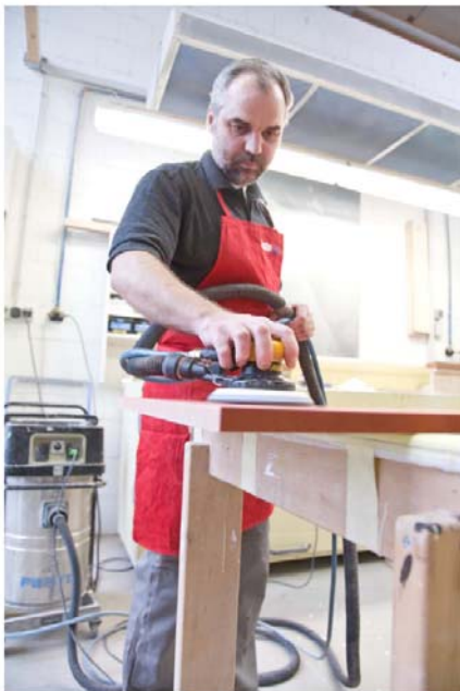
Abb. 3: Zwischenschliff für die Endlackierung
